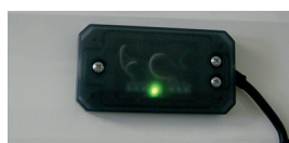
Une barre-palpeuse avec voyant indiquant le bon fonctionnement
