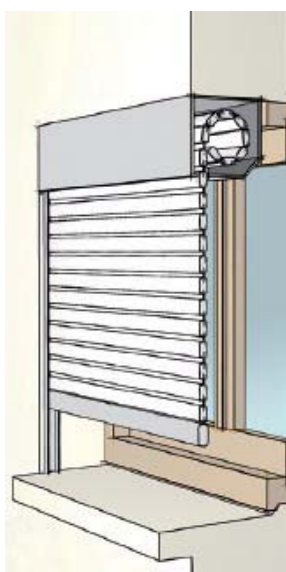
Sous linteau enroulement intérieur
