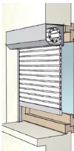
Sous linteau enroulement extérieur
